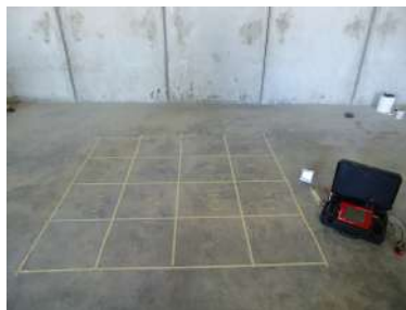
Figg. 14 - 15: Individuazione dell'area di prova; lettura dello spessore
