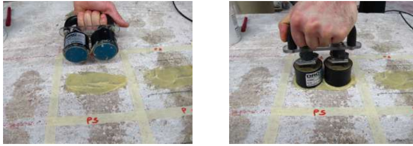
Figg. 7 - 8: Stesura del grasso per l'accoppiamento; posizionamento delle sonde per la misurazione. Risultati ottenuti utilizzando la Procedura ACT e la Procedura FCA sui 12 punti di prova:
