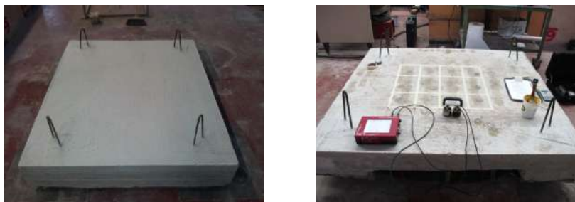
Figg. 5 - 6: Soletta in cls oggetto di indagine; individuazione dei punti di misura
