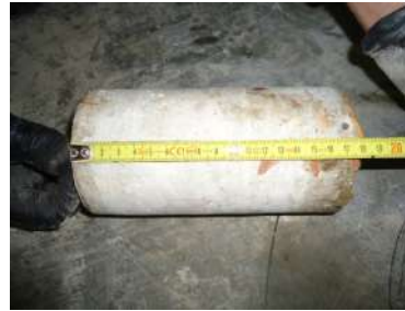
Figg. 12 - 13: Esecuzione di un carotaggio; misura dello spessore sulla carota estratta
