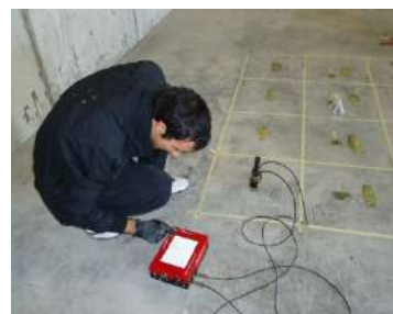
Figg. 14 - 15: Individuazione dell'area di prova; lettura dello spessore
